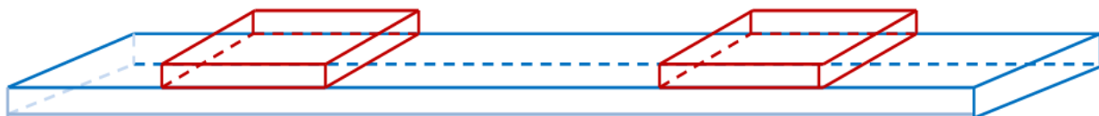
(a) Structures unimorphes et bimorphes piézoélectriques
